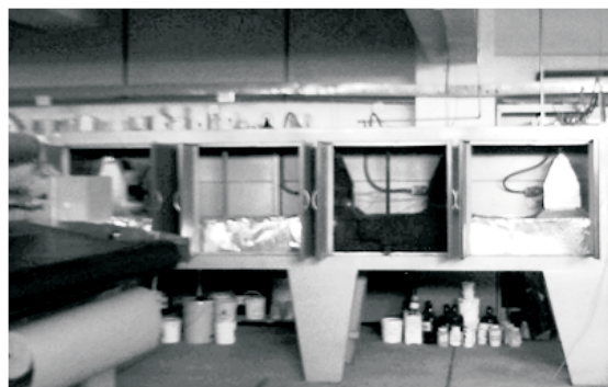
Figura 4. Vista lateral del secador infrarrojo con escudo de radiación de aluminio natural y negro.
