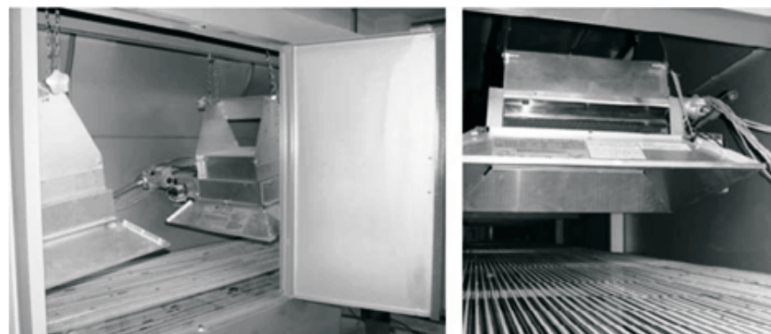
Figura 2. Vista frontal y lateral del secador prototipo infrarrojo sin escudos de radiación.
