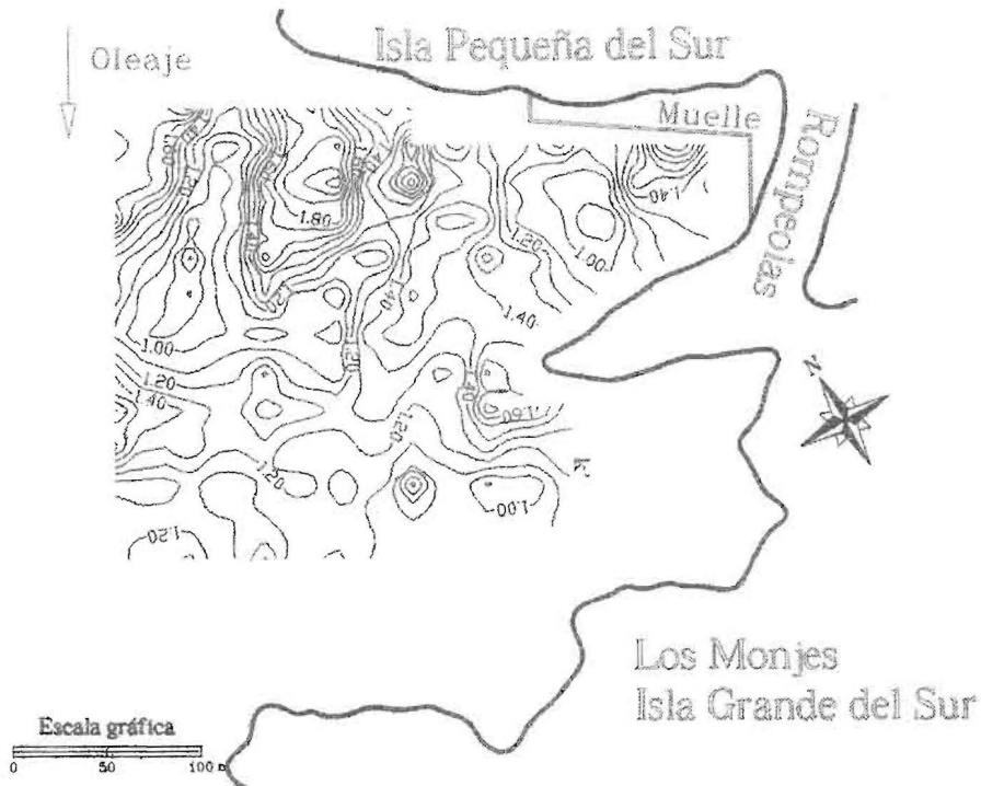
Figura 3. Valores adimensionales de altura de ola ( k' ) para el caso de oleaje de tormenta, T_p=12 s.
