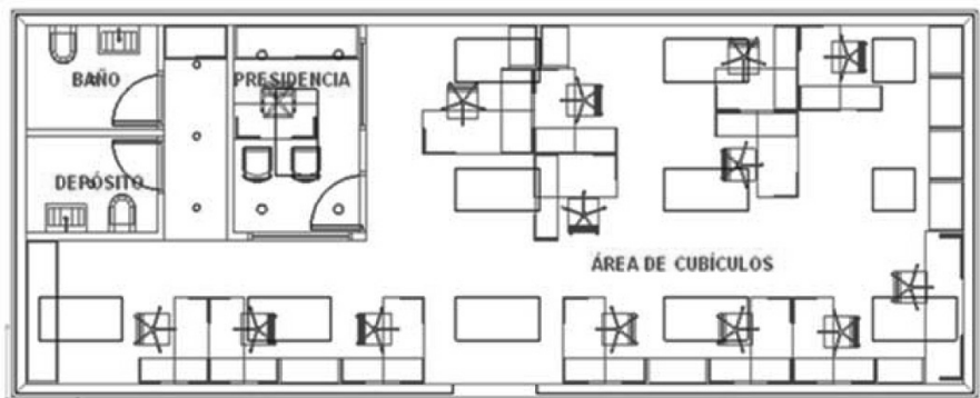
FIGURA 2. Planta distribución espacios y luminarias en el módulo de control (Fuente: Seib, 2008).
