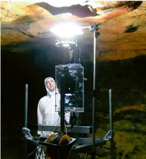
Figura 1. Sistema Spectrarobscan , de la UCM, trabajando en la sala de policromos de la Cueva de Altamira, en Cantabria (España)
