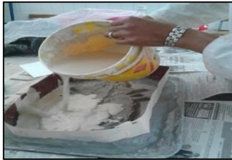
Figura 3. Vaciado del yeso para la elaboración del molde utilizado en la confección del patrón en resina
