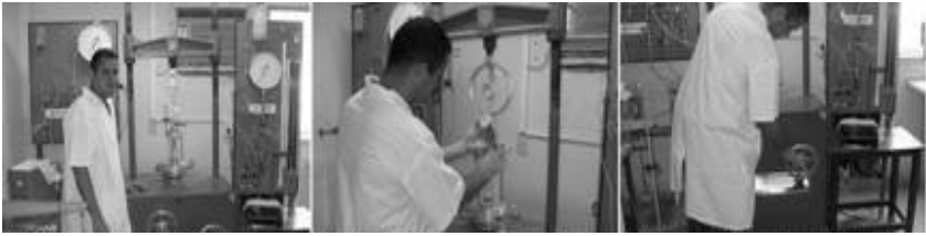
Figura. 3. Aparato de compresión triaxial.
