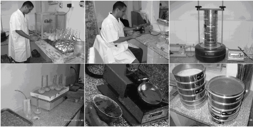
Figura. 1. Determinación de las propiedades físicas del suelo.
